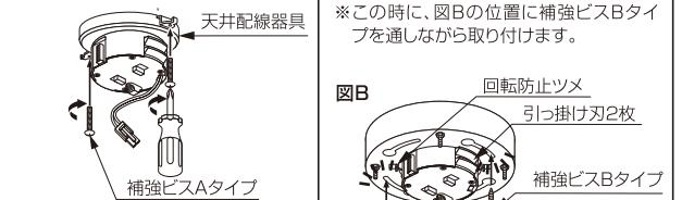
2.補強ビスAタイプを通しながらプラグにシーリングプレートを取り付け、左に回して図Aの位置に仮止めした補強ビスAタイプがくるようにし、ドライバーでしっかりと締めてください。
