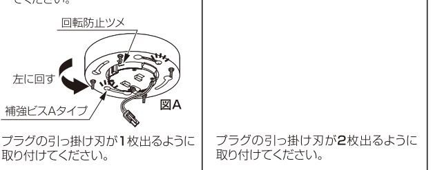
3.補強ビスBタイプを通しながらプラグにシーリングプレートを取り付け、左に回して図Bの位置に仮止めした補強ビスBタイプがくるようにし、ドライバーでしっかりと締めてください。
