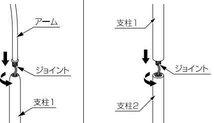
○ コードが捩じれていくと断線の恐れがあるため、必ず下に取り付ける支柱を回してください。
